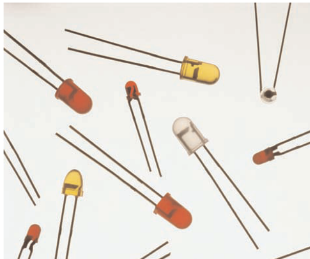
FIGURA 2.8 Aspecto físico del fotodiodo
